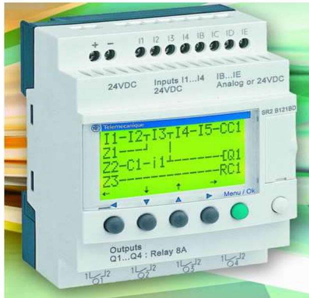
Рисунок 2.3 – Інтелектуальне реле Zelio Logic
